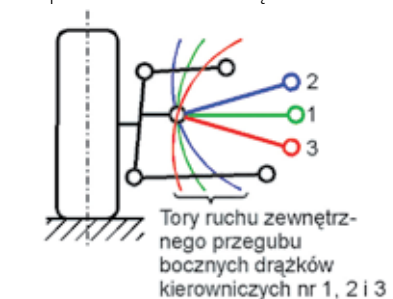
Rys.39 Zmiana ustawienia kół samochodu, podczas ruchu w zakręcie, w celu zmniejszenia tendencji samochodu do nadsterowności.
