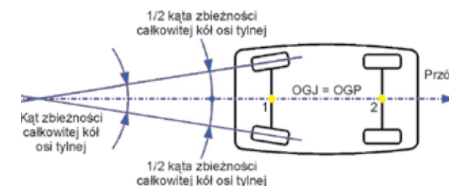
Rys. 11 Oba koła osi tylnej mają ujemny kąt zbieżności połówkowej, o tej samej wartości, dlatego oś geometryczna jazdy OGJ, czyli dwusieczna kąta zbieżności całkowitej kół osi tylnej, pokrywa się z osią geometryczną podwozia OGP (przechodzi ona przez środki 1 i 2 osi tylnej i przedniej).
