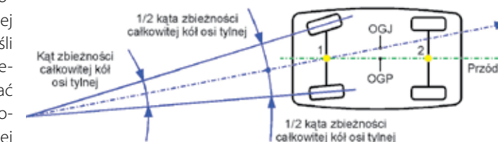
Rys. 13 Kąt zbieżności połówkowej koła lewego tylnego jest ujemny, a kąt zbieżności połówkowej koła prawego tylnego jest dodatni, dlatego oś geometryczna jazdy OGJ, czyli dwusieczna kąta zbieżności całkowitej kół osi tylnej, nie pokrywa się z osią geometryczną podwozia OGP (przechodzi ona przez środki 1 i 2 osi tylnej i przedniej).
