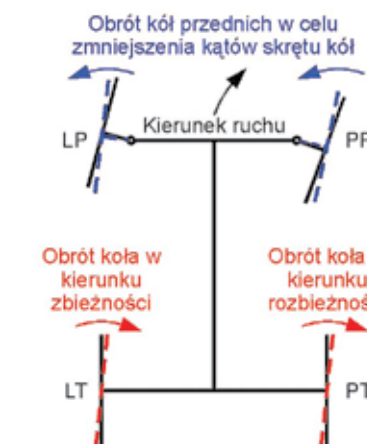
Rys.39 Zmiana ustawienia kół samochodu, podczas ruchu w zakręcie, w celu zmniejszenia tendencji samochodu do nadsterowności.
